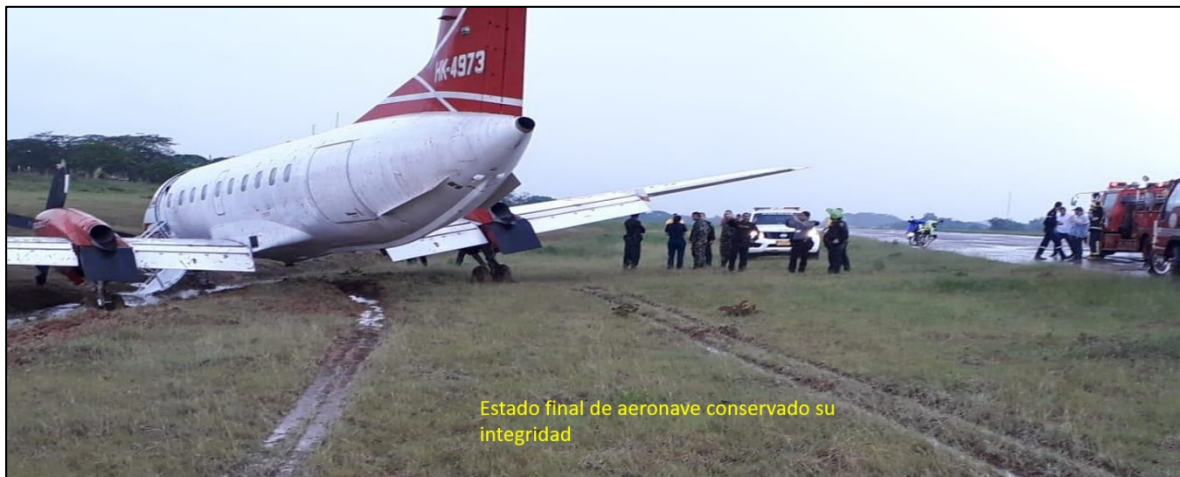
Fotografía No. 2: Marcas del tren de aterrizaje y posición final de la aeronave.
