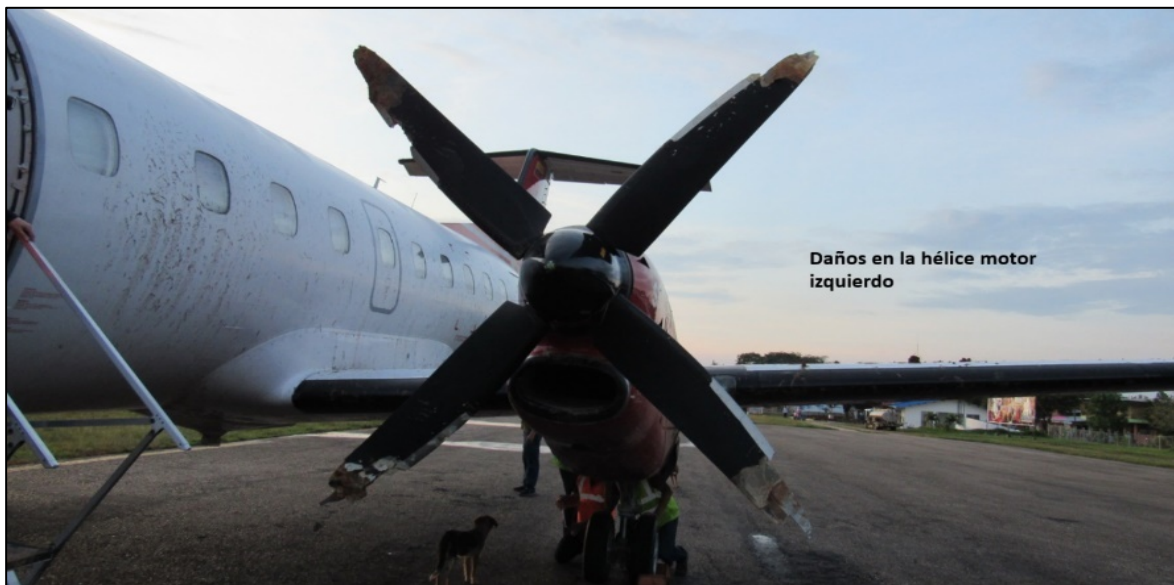
Fotografía No. 3: Daños en la hélice del motor izquierdo.
