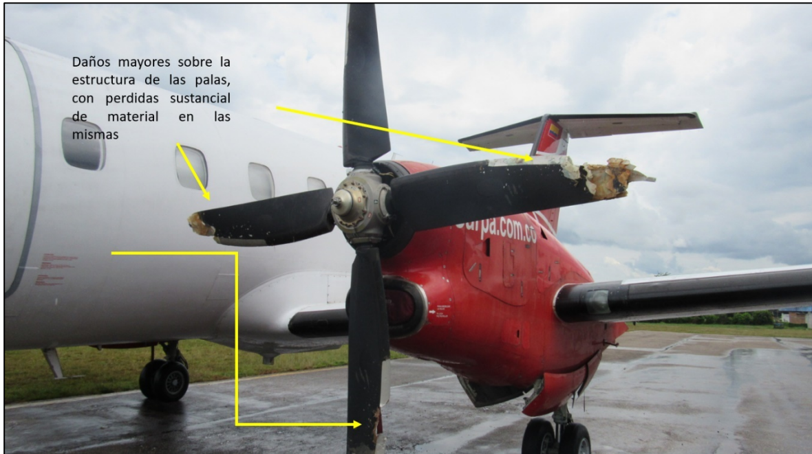
Fotografía No. 8: Daños sustanciales en la estructura de la hélice.
