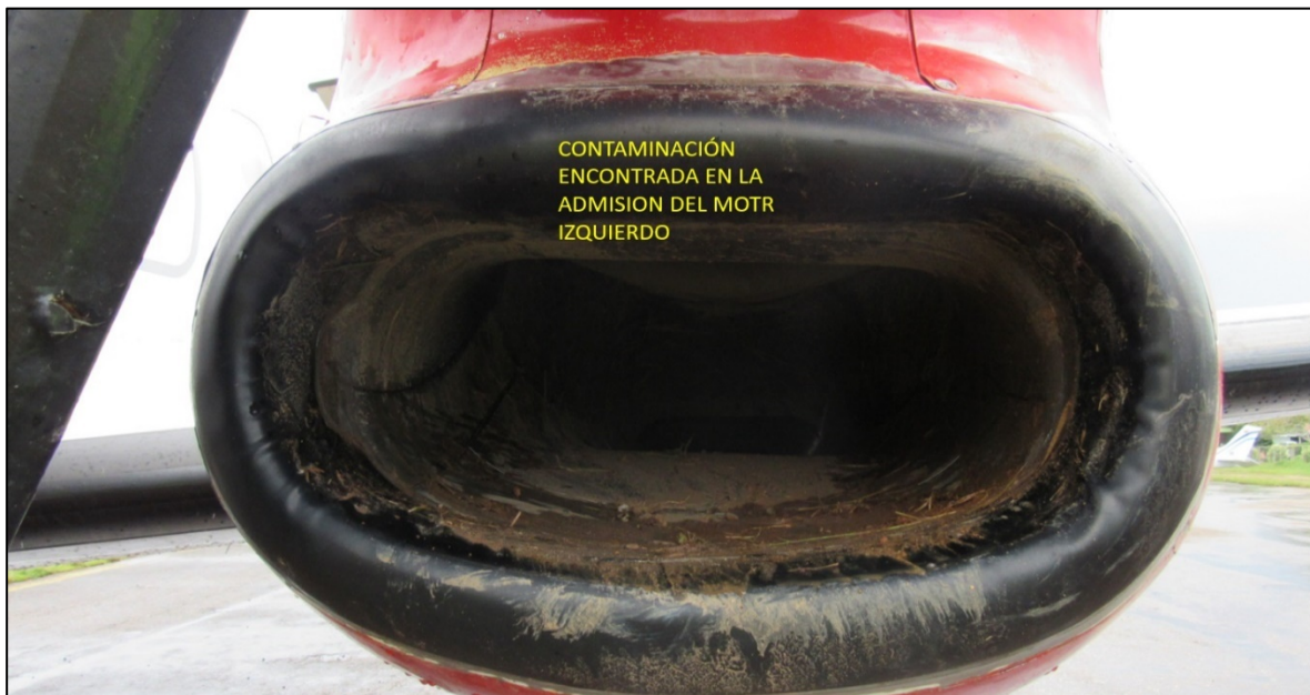
Fotografía No. 9: Contaminación motor izquierdo.
